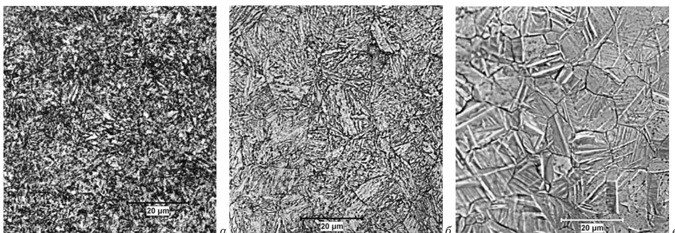
Рис. 1. Микроструктура стали 38ХМА после травлений в 4 %-м спиртовом растворе азотной кислоты (а), в реактиве Маршалла (б) и вакуумного травления (в)
