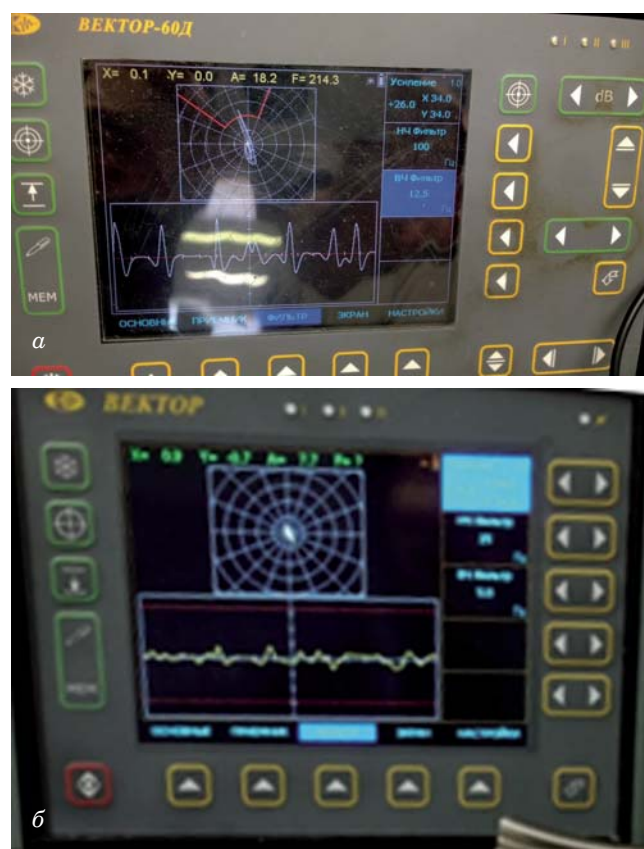
Рис. 3. Вихретоковый сигнал на мониторе дефектоскопа от дефекта (неполное проплавление, непровар в корне сварного шва) (а) и бездефектной области (б) сварного соединения тантала толщиной 0,5 мм
