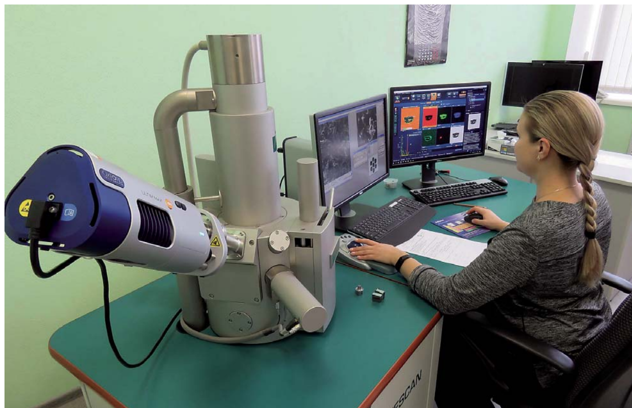
Рис. 1. Микрозондовый анализ неметаллических включений
