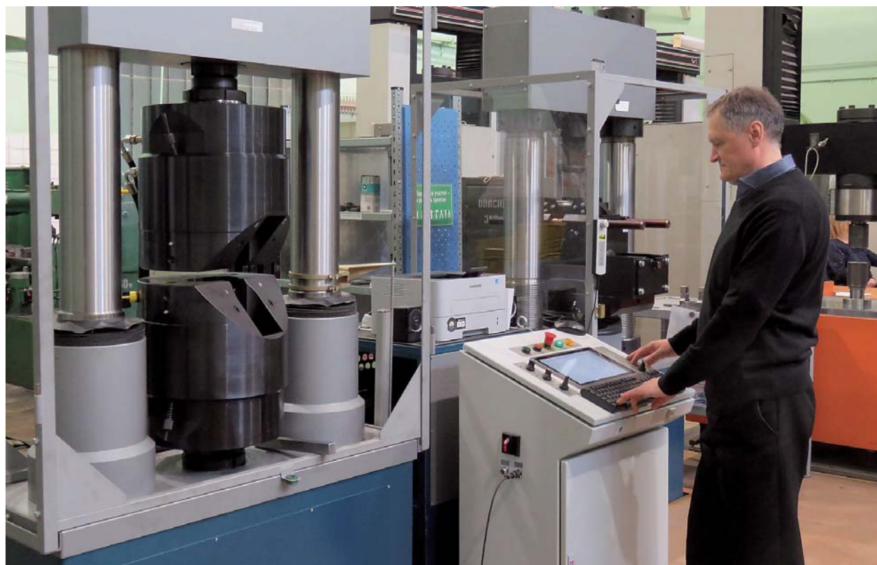
Рис. 2. Испытания на статический изгиб и растяжение
