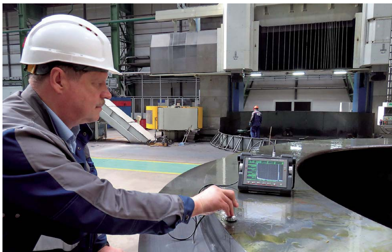
Рис. 3. Проведение ультразвукового контроля заготовок
