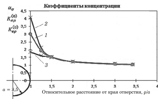
Рис. 4. Изменения теоретических коэффициентов концентрации напряжений в упругой области \alpha_\sigma (1), а также коэффициентов концентрации деформаций K_{\epsilon p}^{(0)} (2) и напряжений K_{\sigma p}^{(0)} (3) в упругопластической области по ширине полосы при исходном нагружении
