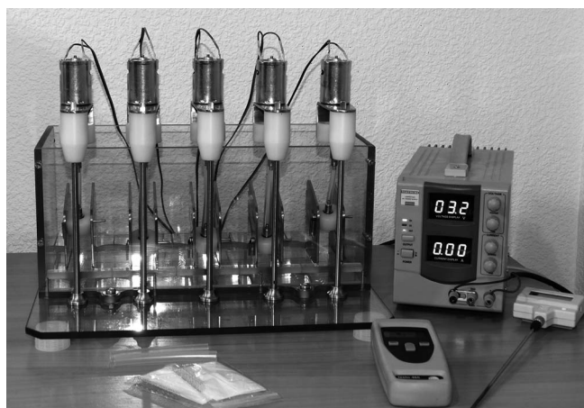
Рис. 1. Установка по определению усталостной долговечности стентов
