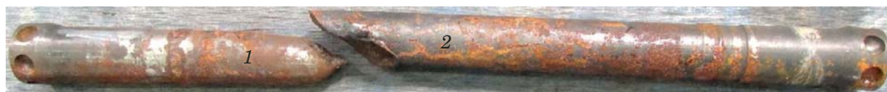
Рис. 1. Фрагменты карданного вала
