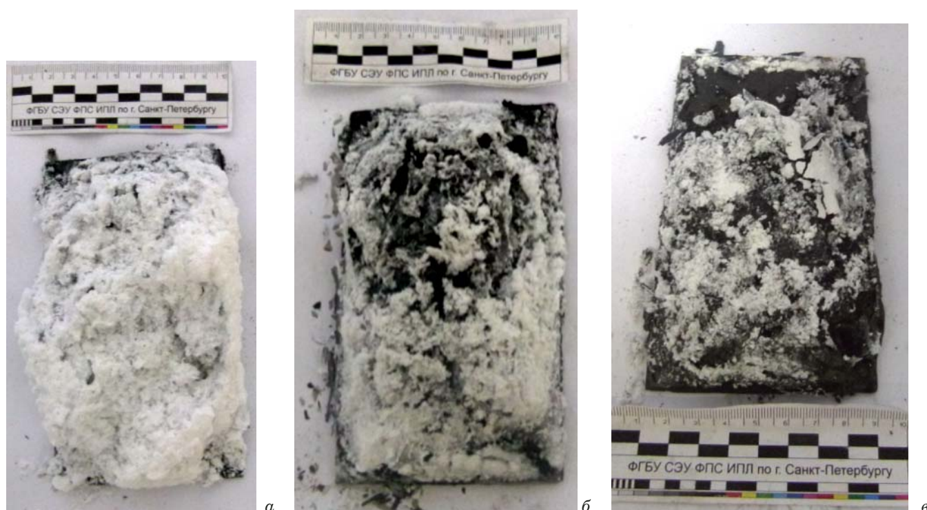
Рис. 6. Образцы ОВП 1 после нагрева: а — исходный; б, в — состаренные на 3 и 6 лет соответственно
