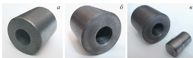
Рис. 2. Исходное состояние приспособления: а и б — матрицы — виды со стороны отверстий меньшего и большего диаметров; в — матрица и пуансон
