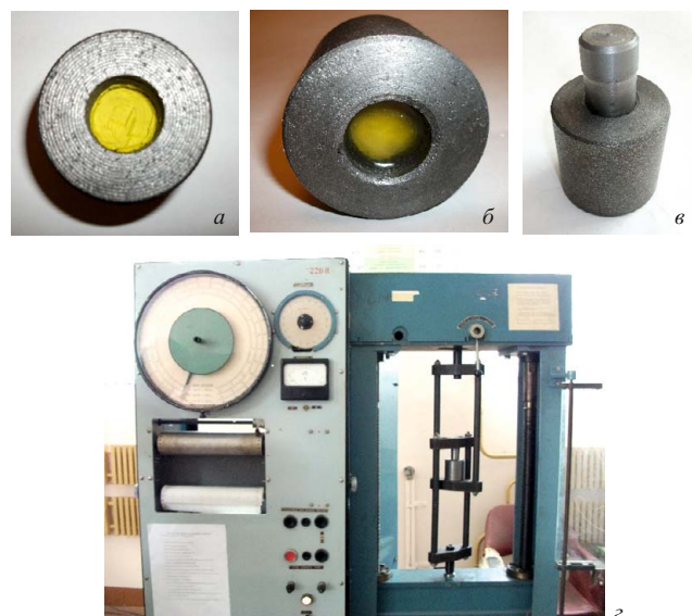
Рис. 3. Схема сборки образца и проведения испытания: а — пластилиновая вставка; б — сформированный испытуемый материал; в — собранный образец; г — испытание на разрывной машине Р-05
