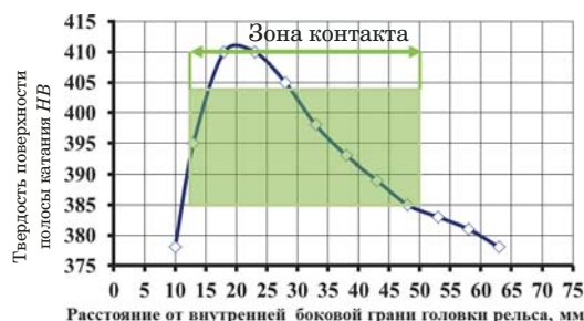
Рис. 11. Распределение твердости по поперечному сечению рельса на прямом участке пути
