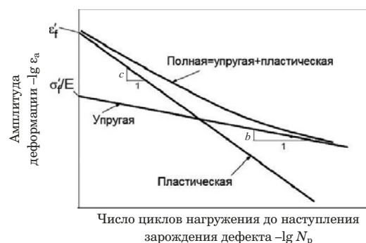
Рис. 4. Деформационные кривые усталости
