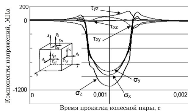
Рис. 8. Изменение компонент тензора напряжений в точке поверхности катания рельса при прокатывании колеса: \sigma_{xx} , \sigma_{yy} , \sigma_{zz} — нормальные напряжения тензора вдоль осей X , Y , Z ; \tau_{xy} , \tau_{yz} , \tau_{xz} — касательные напряжения на площадках
