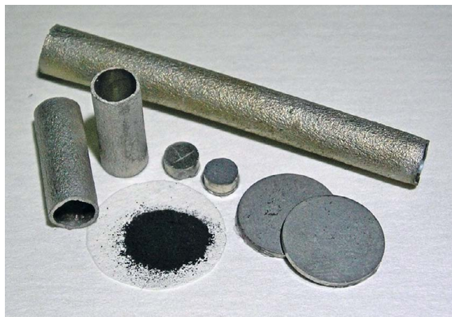
Рис. 1. Внешний вид исходного НП иридия и изделий из него (трубок, дисков), изготовленных магнитно-импульсным пресованием
