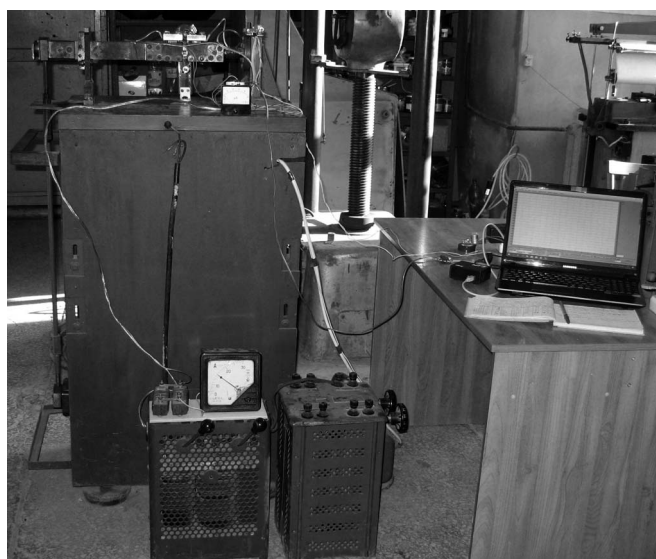
Рис. 1. Установка для усталостных испытаний образцов на циклический изгиб
