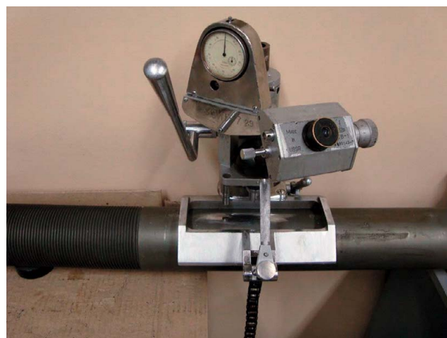
Рис. 3. Общий вид прибора МЭИ-Т7, закрепленного на шпильке
