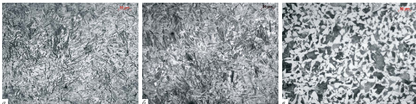
Рис. 1. Микроструктура стали 32Г2, закаленной с температуры 860 °С в воду (а), в масло (б), на воздухе (в)
