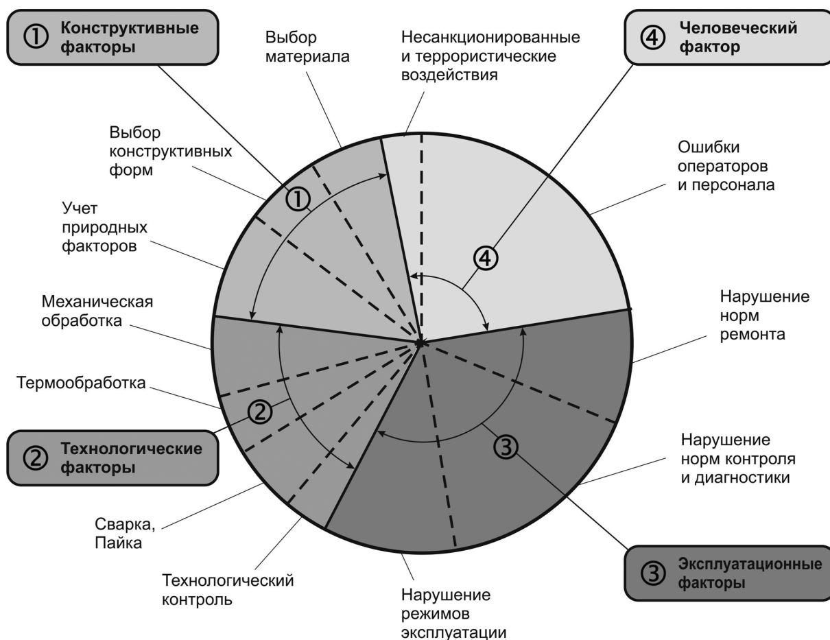
Рис. 1. Относительное распределение источников и причин возникновения тяжелых аварий и катастроф в гражданском комплексе
