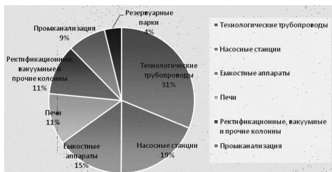
Рис. 2. Распределение аварий по объектам технологического оборудования нефтегазового и топливно-энергетического комплексов
