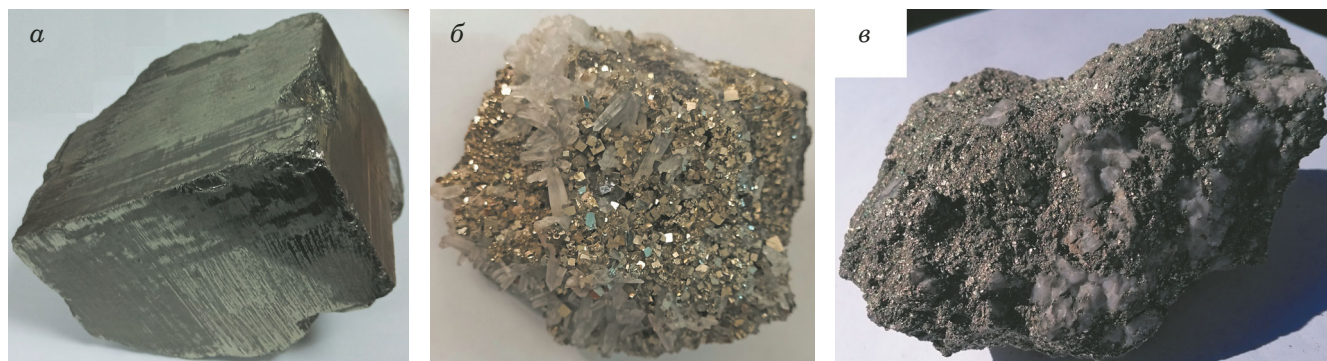
Рис. 1. Фотографии образцов пирита с разными размерами кристаллов: a — 10 × 15 × 12 см; б — ~1 см; в — до 1 мм и менее (микросульфид)
