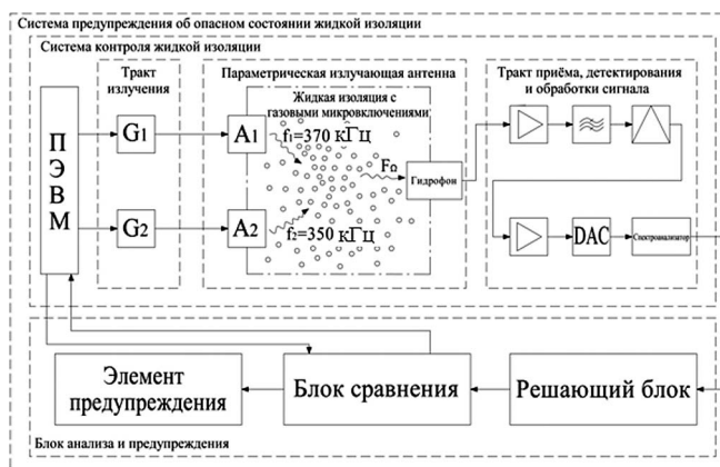
Рис. 1. Структурная схема устройства для предупреждения об опасном состоянии ЖИ МВВЭО
