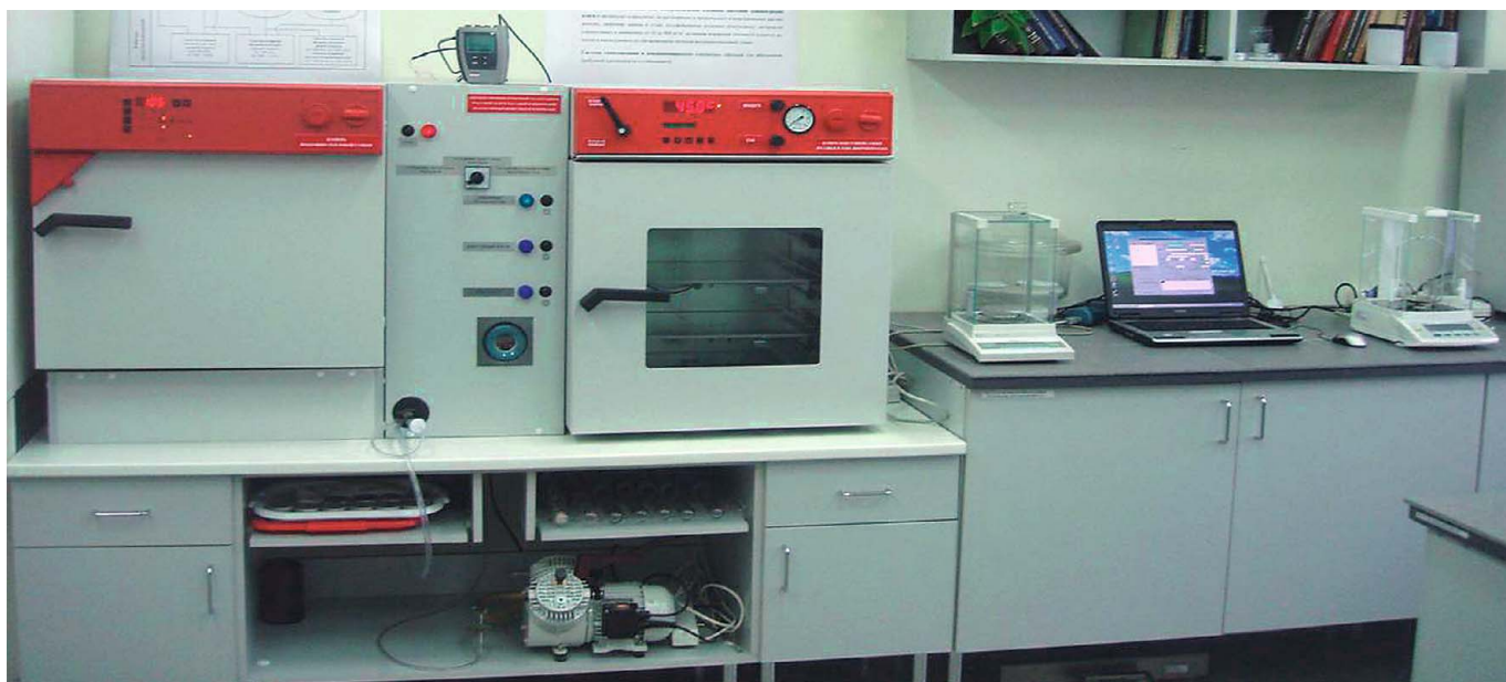
Рис. 1. Внешний вид эталонного комплекса, реализующего термогравиметрические методы
