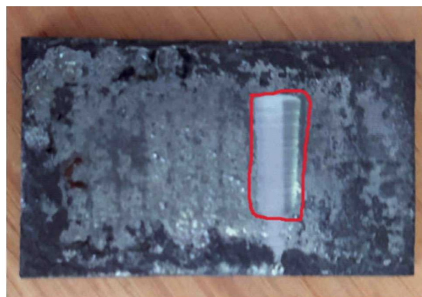
Рис. 2. Зона контакта образца с абразивной лентой
