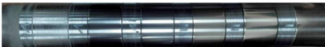
Рис. 1. Покрытия на стали 40, сформированные газопламенным напылением
