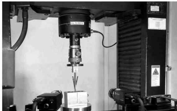
Рис. 1. Общий вид стандартного образца типа ДКБ для определения межслоевой трещиностойкости тонколистовых УКМ (а) и вид испытательного узла для расклинивания образца (б)
