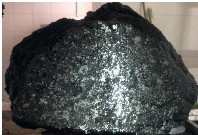
Рис. 1. Изображение образца конвертерного ванадиевого шлака в разрезе
