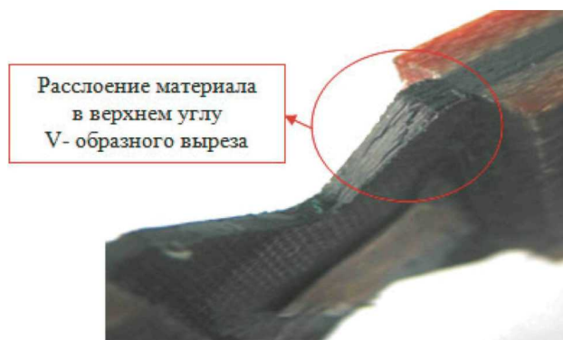
Рис. 15. Характер разрушения образца после испытания по ASTM D 5379
