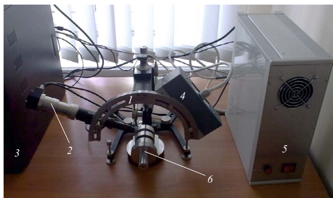
Рис. 3. Рикор-7: 1 — гониометрический узел; 2 — рентгеновская трубка; 3 — персональный компьютер; 4 — детектор; 5 — вычислительный блок; 6 — заготовка
