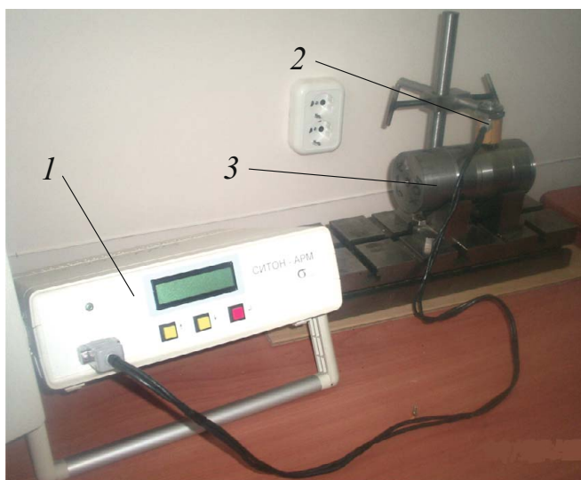
Рис. 2. СИТОН-АРМ: 1 — измерительный комплекс; 2 — датчик; 3 — заготовка
