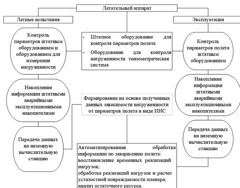
Рис. 1. Общая схема мониторинга нагруженности ЛА с применением ИНС
