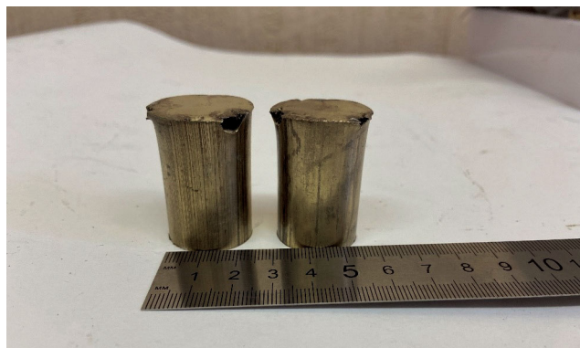
Рис. 3. Сохраненные образцы бронзы после соударения с пластиной-ударником без обоймы
