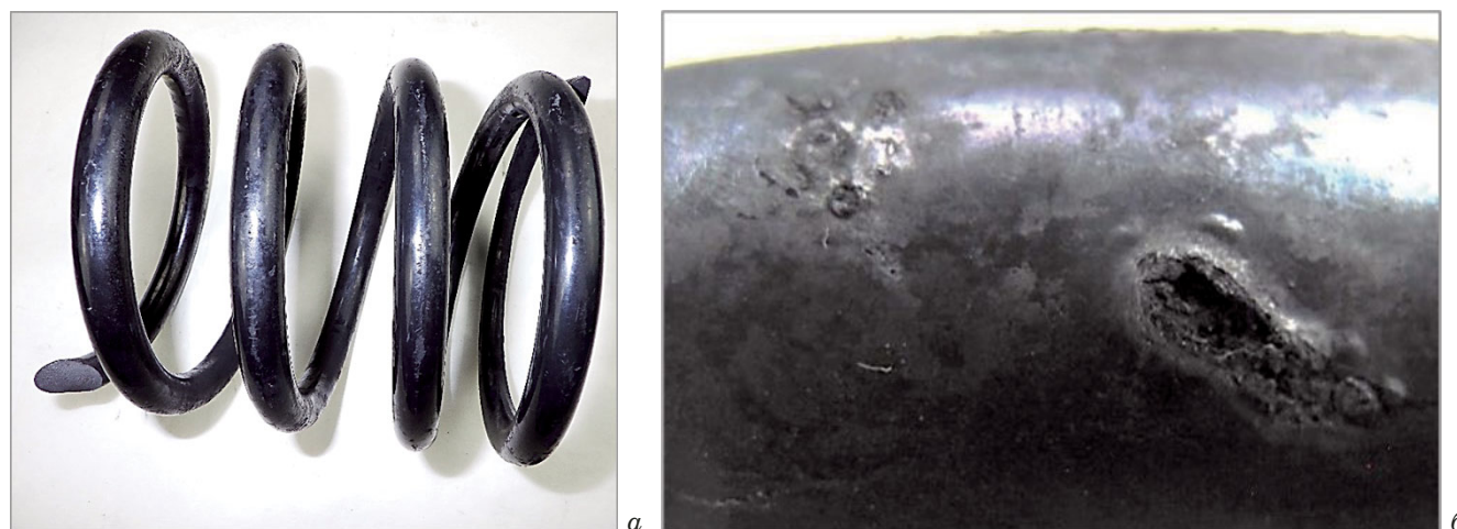
Рис. 1. Фрагменты пружины после разрушения: a — общий вид; б — дефекты на витках
