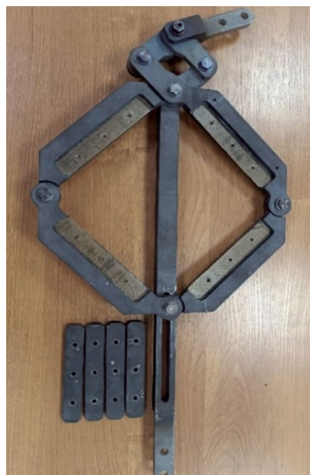
Рис. 2. Оснастка для проведения теста рамкой
