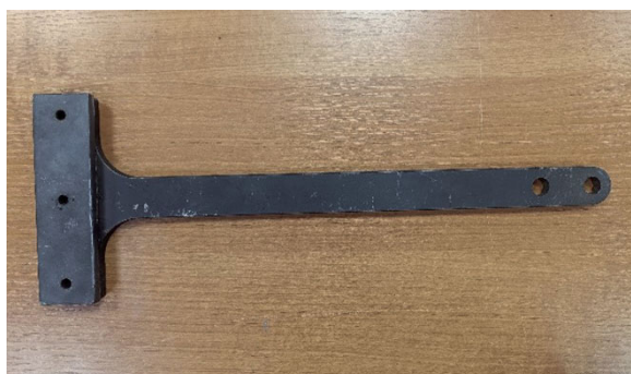
Рис. 3. Оснастка для проведения испытаний на растяжение-смещение
