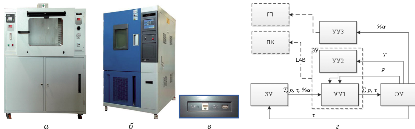
Рис. 2. Оборудование ускоренного старения и деградации полимерных материалов NoseLab ATS: а, б — модели оборудования с графическим принтером и интегрированным электронным устройством LAB; в — интерфейсное устройство LAB; з — структурная схема управления
