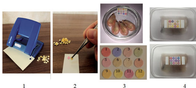
Рис. 1. Схема изготовления тест-устройства и измерения цветометрических характеристик индикаторных зон смартфоном: 1 — изготовление индикаторных зон с помощью дырокола; 2 — приклеивание индикаторных дисков на двухсторонний скотч; 3 — расположение индикаторов (номер индикаторной зоны соответствует номеру индикатора из таблицы); 4 — фотографии, полученные с помощью смартфона при исследовании порчи зубатки (верхняя — свежая, нижняя — испорченная).
