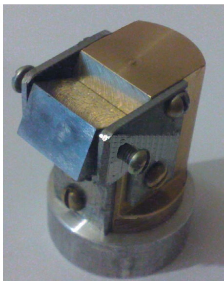
Рис. 1. Держатель крупногабаритных образцов для ДОО-исследований
