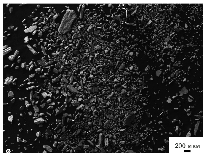
Рис. 8. Продукты износа образцов B83 гп + 3 \% масс. Ti_2NbAl (а) и B83 сн (б)
