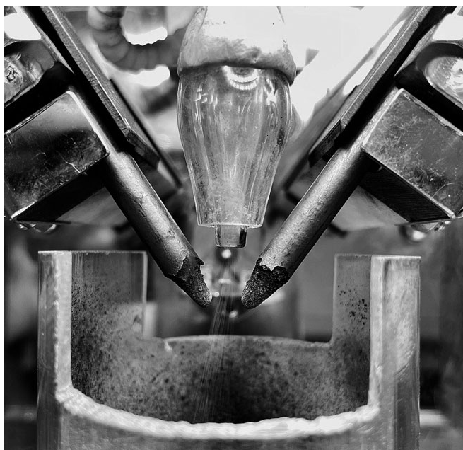
Рис. 7. Фото воронки при одновременной подаче пробы и аргона на уровне 0,75 л/мин
