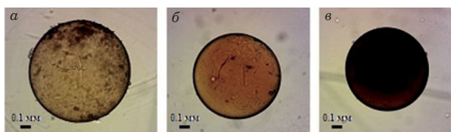
Рис. 3. Фотоизображения гранул, полученные при импрегнировании ПВС солями железа (III) и (II) с концентрациями (моль/дм 3 ): a — 0,02 и 0,01 соответственно; b — 0,05 и 0,025; c — 0,10 и 0,05
