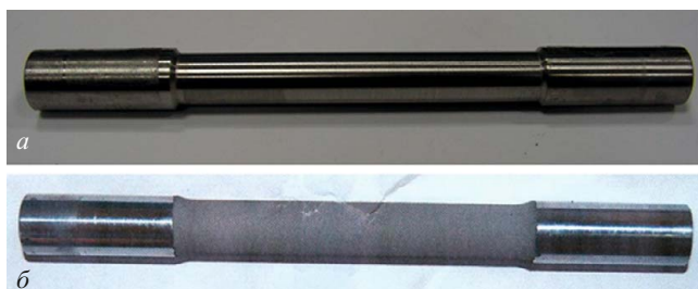
Рис. 2. Гладкие цилиндрические образцы диаметром d = 10 мм: a и б — в исходном состоянии и с покрытием HVAF
