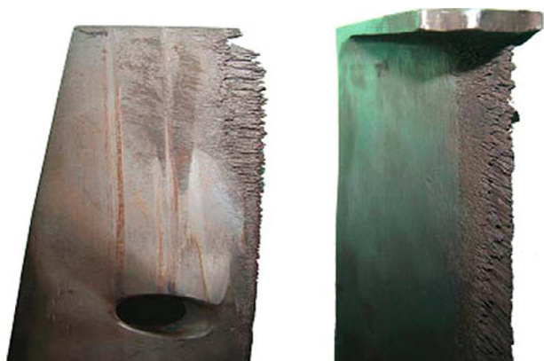
Рис. 1. Виды эрозионного износа рабочих лопаток паровых турбин
