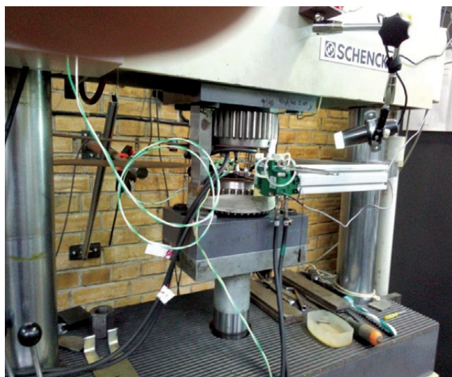
Рис. 1. Образец в захватах испытательной машины POZN с установленным экстензометром и токосъемниками системы нагрева
