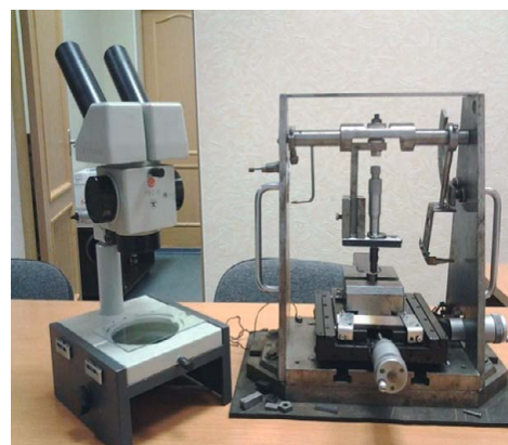
Рис. 4. Внешний вид устройства (справа) для маятникового скрайбирования
