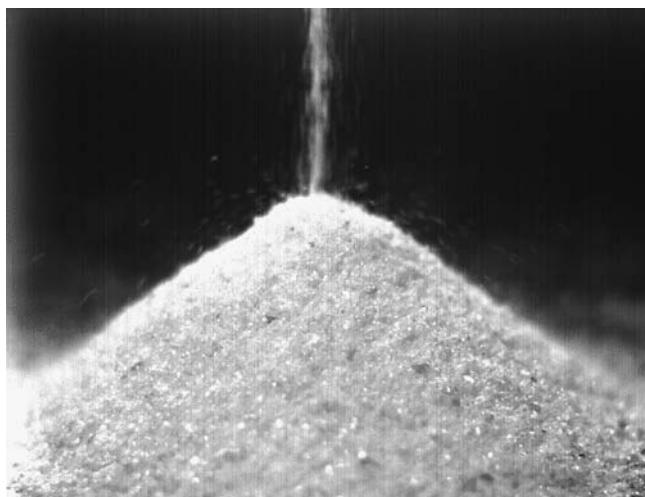
**Рис. 10.** Фрагмент высокоскоростной регистрации соударения потока гранул с вершиной насыпного конуса (скорость съемки 500 кадров в секунду)
