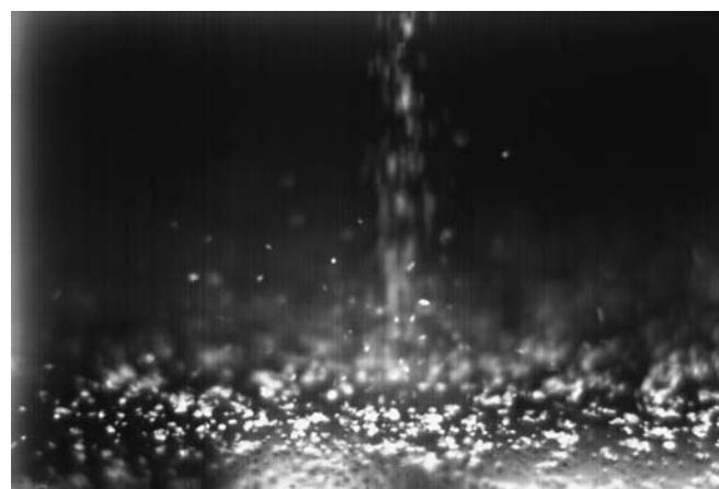
**Рис. 5.** Фрагмент видеорегистрации соударения потока гранул с поверхностью стекла на первой секунде эксперимента (скорость съемки 500 кадров в секунду)
