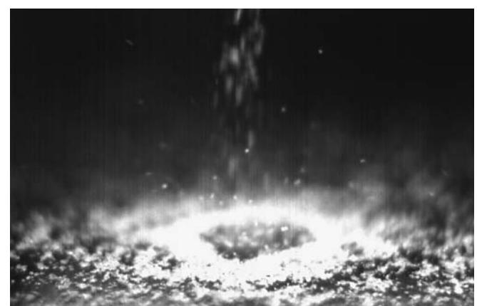
**Рис. 6.** Фрагмент формирования основания насыпного конуса на второй секунде эксперимента (скорость съемки 500 кадров в секунду)
