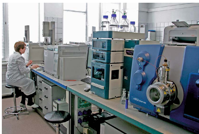
Рис. 2. Сектор хроматографии: определение органических веществ в воде
