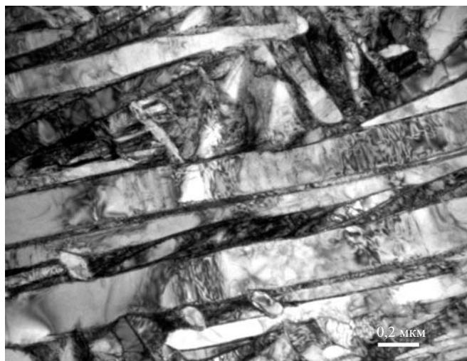
Рис. 6. Изображение участка \beta -превращенного зерна: а) светопольное; б) темнопольное с соответствующей дифракционной картиной (ось зоны [110]_{\beta} )
