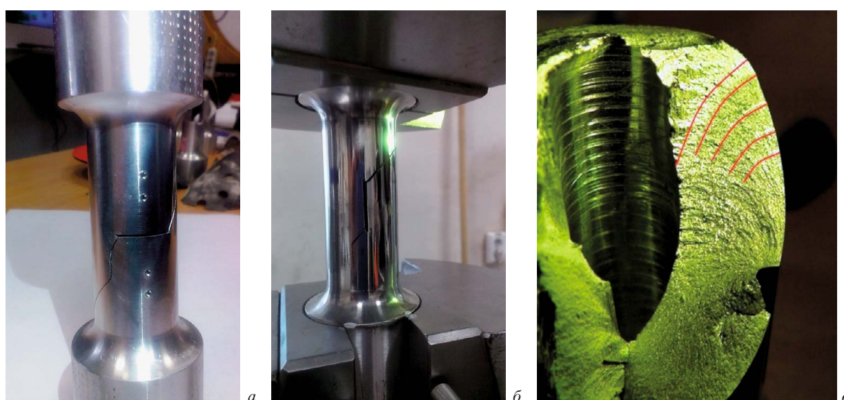
Рис. 4. Траектория развития трещины при кручении для поперечного (а) и продольного (б, в) расположений исходного надреза
