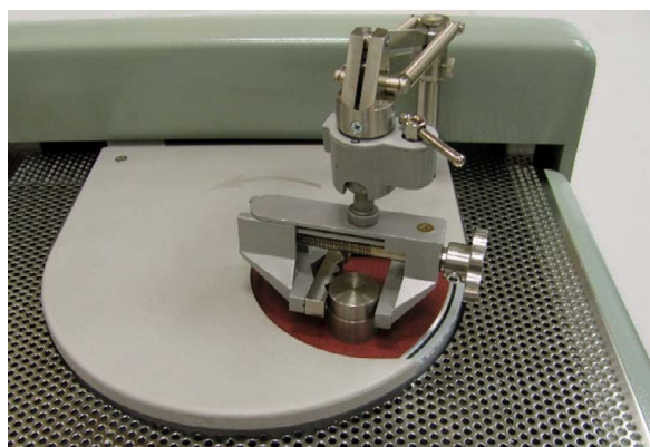
Рис. 4. Правый диск шлифовального станка
