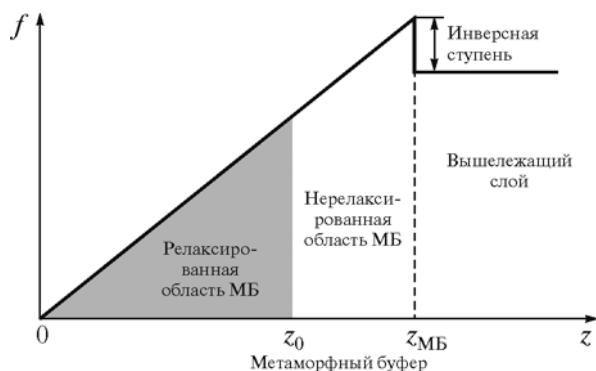
Рис. 1. Схема частично релаксированного МБ [5]
