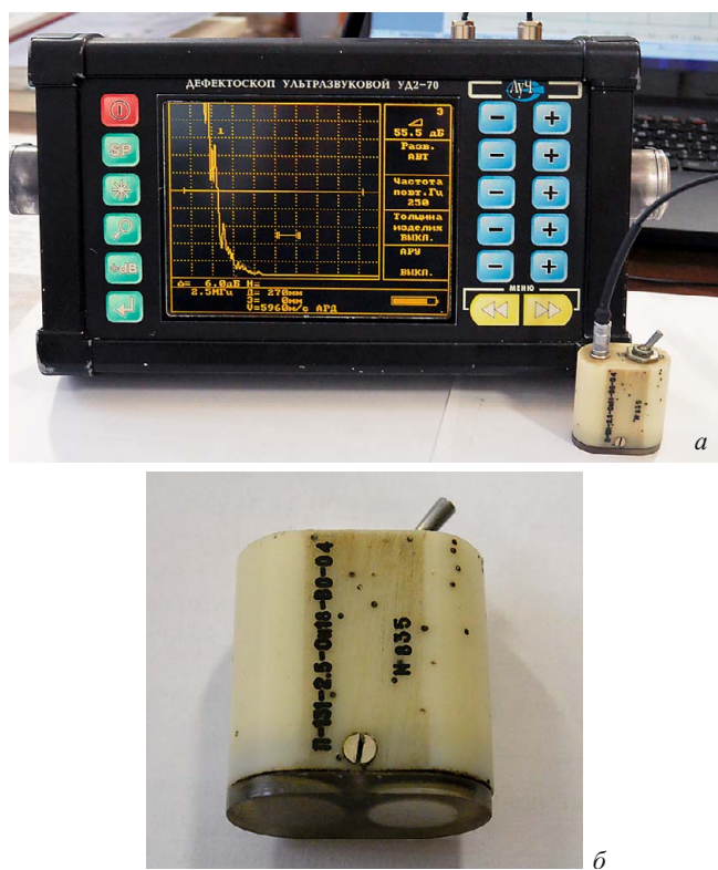
Рис. 1. УЗ импульсный дефектоскоп УД2-70 (а) и комбинированный пьезоэлектрический преобразователь П131-2,5-0и18-BO-04 (б)
