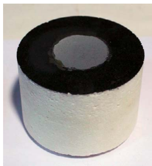
Рис. 2. Образец в державке из штатной плитки ОК «Буран»
