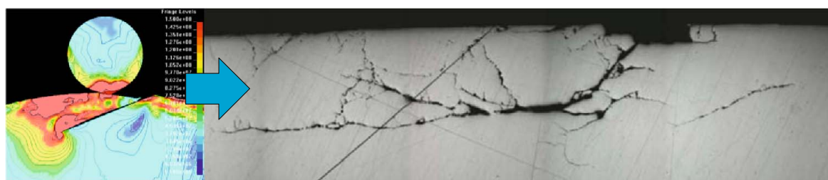
Рис. 8. Бифуркация микротрещин в условиях трения качения
