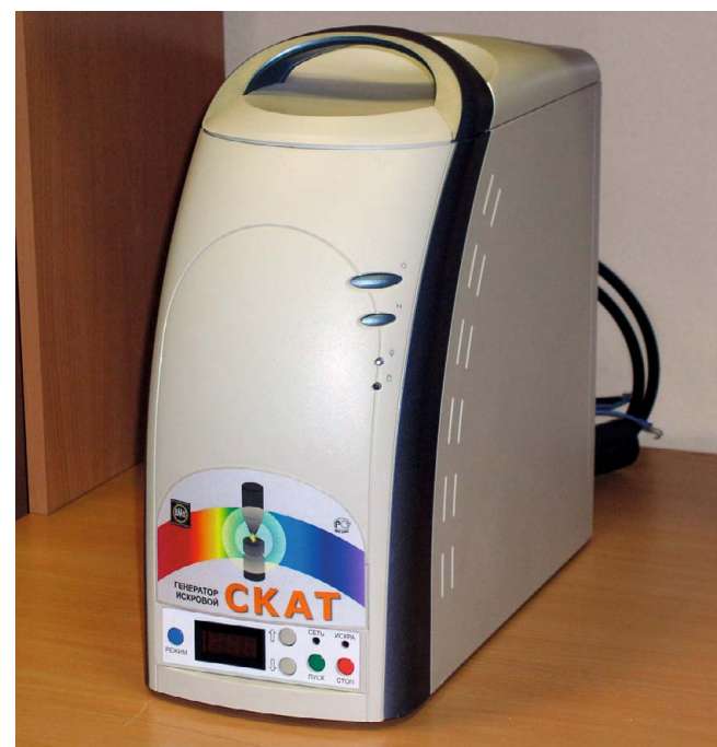
Рис. 2. Искровой генератор «СКАТ»
