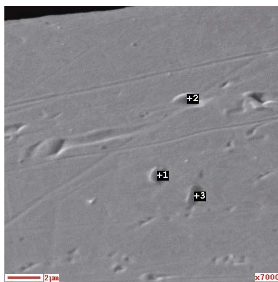
Рис. 10. Изображение частиц оксикарида титана в приповерхностной зоне образца, подвергнутого обработке ионным потоком
