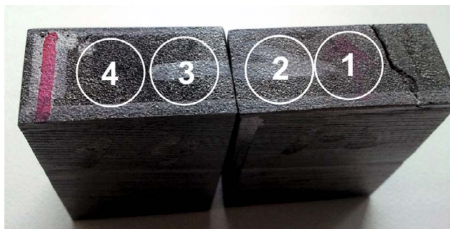
Рис. 8. Схема расположения областей определения химического состава относительно дефекта
