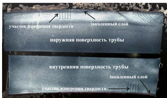
Рис. 5. Наружная и внутренняя поверхности трубы с участками измерения твердости
