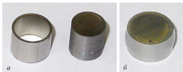
Рис. 3. Составной образец для испытаний на сжатие: а и б — до и после испытания
