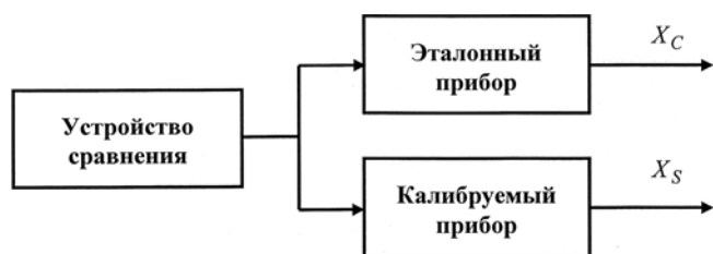
Рис. 2. Структурная схема калибровки СИ сличением с эталонным СИ
